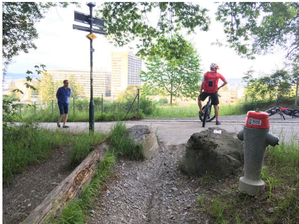
Einfache Schikane/Verengung auf MTB-Route vor Einmündung auf eine Strasse (Quelle: BikePlan AG > Uetliberg-Trail)
